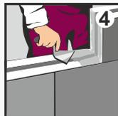
4. Монтаж ПГП: нанесите клей по всей площади пазов плиты и с усилием придавите его следующей плитой. Снимите излишек клея. После полного высыхания клея (не ранее, чем через 4 часа) зашлифуйте неровности. Толщина вертикальных и горизонтальных швов должна быть не более 2 мм.
