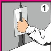
1. Подготовьте основание. Впадины, трещины и неровности выровняйте штукатурными составами БОЛАРС. Обработайте основание грунтовыми составами БОЛАРС, соответствующими Вашему типу поверхности.
